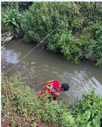
Ilustración 20. Recolección de muestra de solidos de fondo
