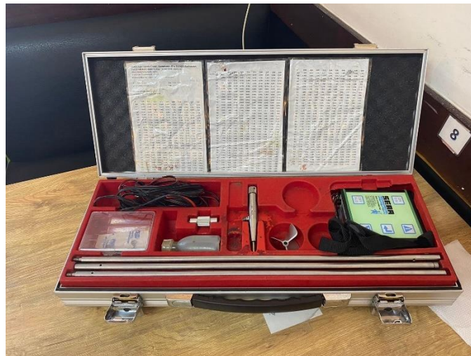
Ilustración 11. Correntómetro Tipo Molinete
